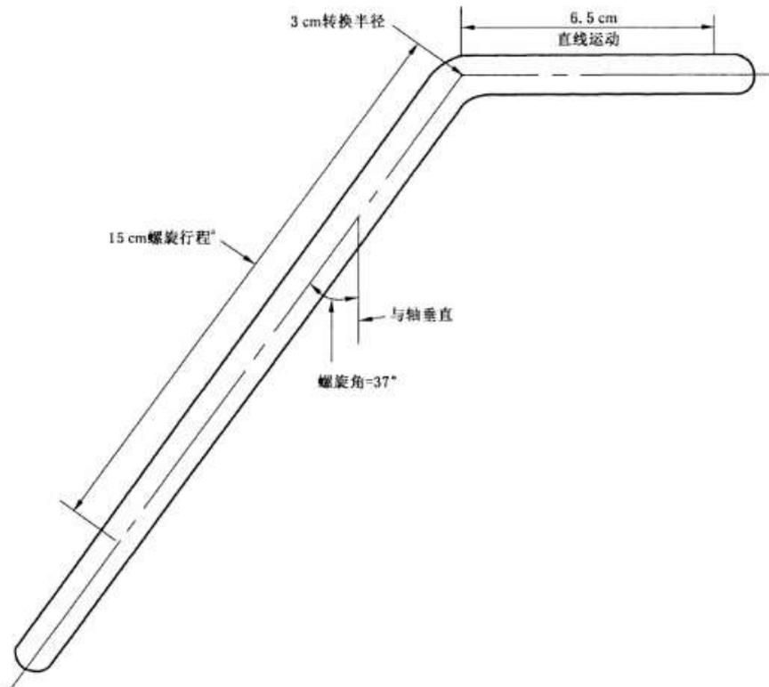
\* 15 cm 的螺旋运动= $440^\circ$ 的旋转运动与9 cm的轴向运动。
